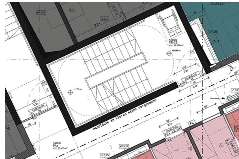
Treppenauge 0,45m x 2,7m Fallhöhe 5 Geschosshöhen
