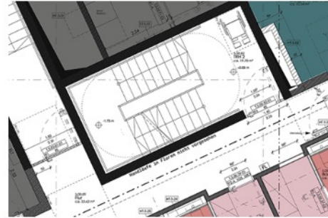
Treppenaug 0,45m x 2,7m Fallhöhe 5 Geschosshöhen
